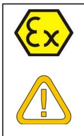
Nur die Geräteversionen TS125L-Ex, TS125LP-Ex TS125M-Ex und TS225M-Ex sind für den Einsatz als zugehörige Betriebsmittel zum Anschluss von eigensicheren Sensoren, montiert in den Zonen 0 oder 1, bzw. 20 oder 21, zugelassen.
