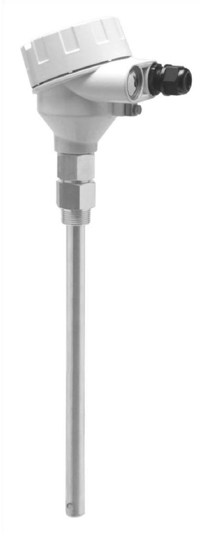
4-Draht-TDR-Füllstandssensor mit Stab-, Seil- oder Koaxialsonde für die kontinuierliche Füllstandmessung und die Grenzstanderkennung in Flüssigkeiten und leichten Feststoffen mit Analog- und Schaltausgang.
